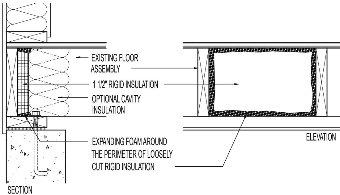
EXISTING BAND JOIST INSULATION RETROFIT WITH 1 1/2" RIGID INSULATION
