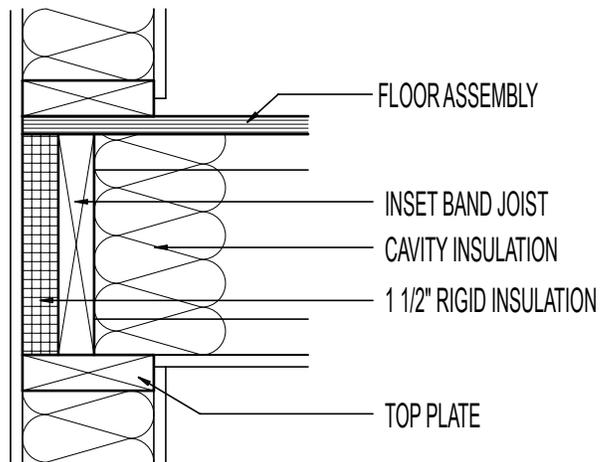
INSET BAND JOIST AT TOP PLATE
