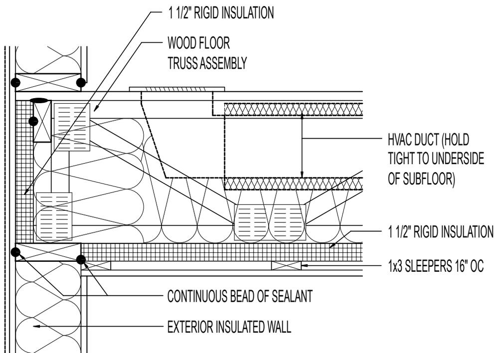
INSET BAND JOIST AT WOOD FLOOR TRUSS
