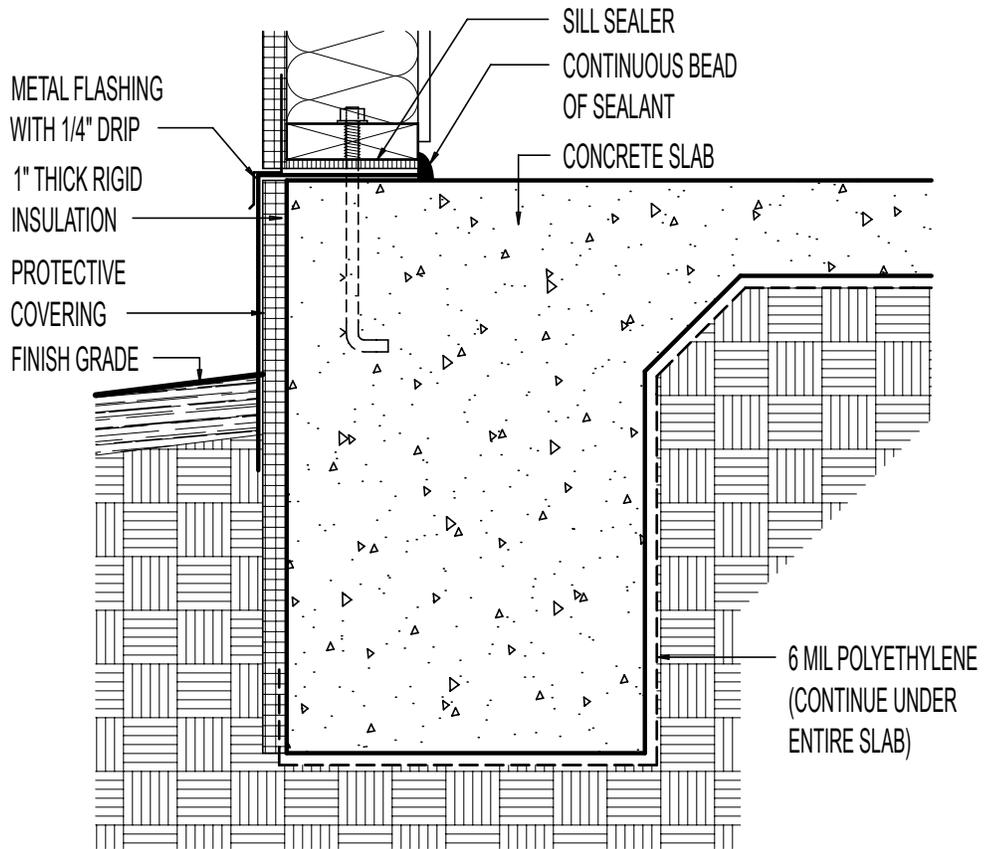
TURNED DOWN CONCRETE SLAB // 1" RIGID INSULATION
