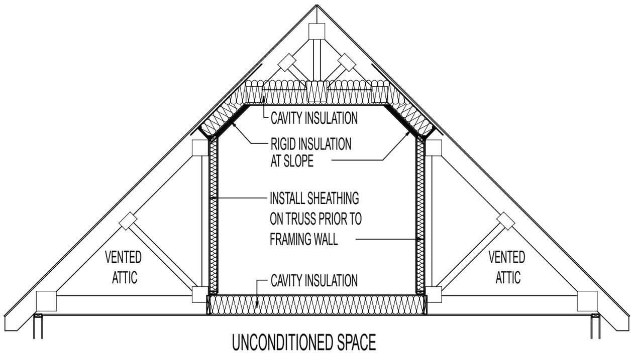
CONCEPTUAL INSULATION PRACTICE AT ATTIC-STYLE TRUSS SYSTEM //
