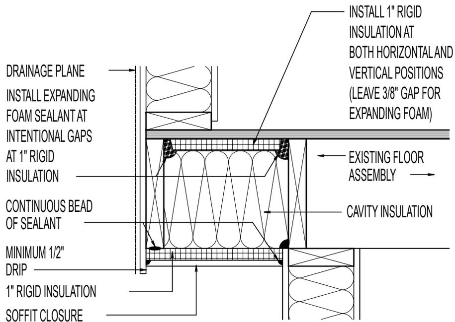
INSULATED CANTILEVER FLOOR // CAVITY INSULATION WITH
