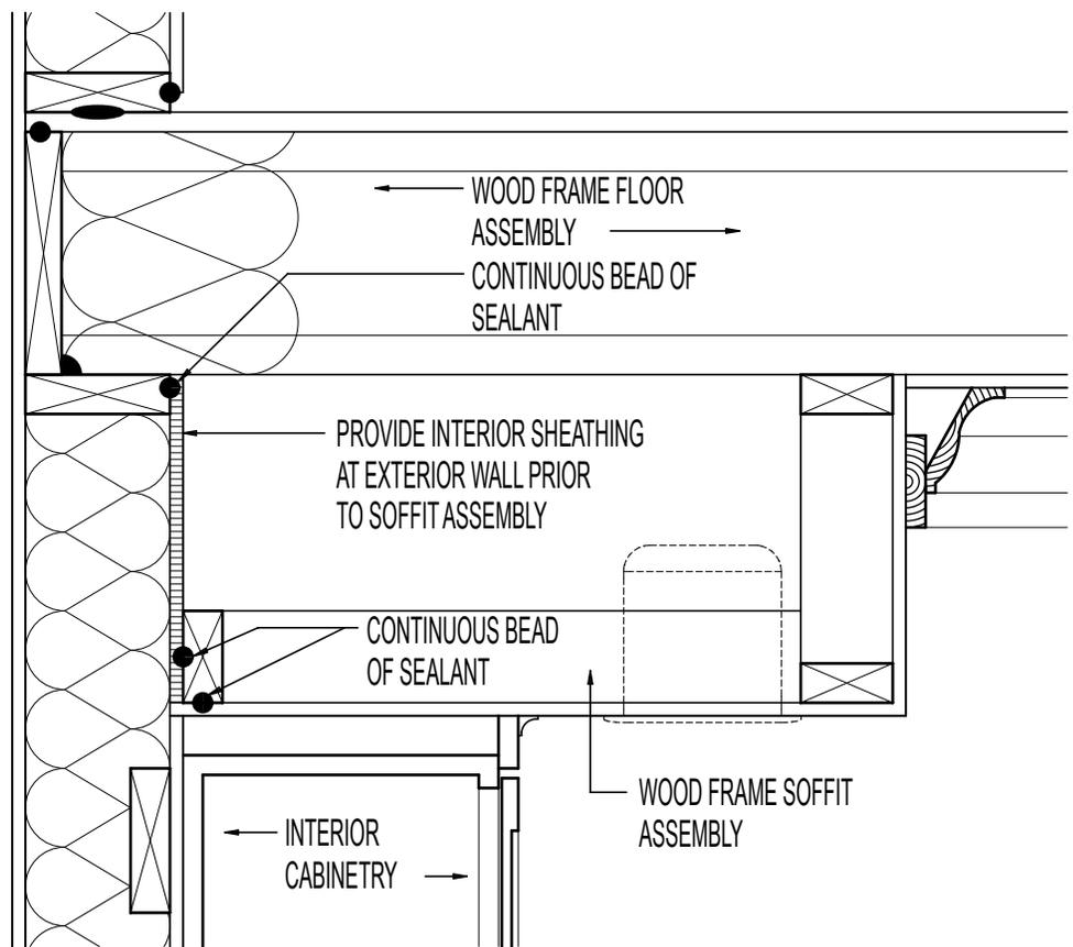
AIR SEAL AT CABINET SOFFIT // TWO-STORY
