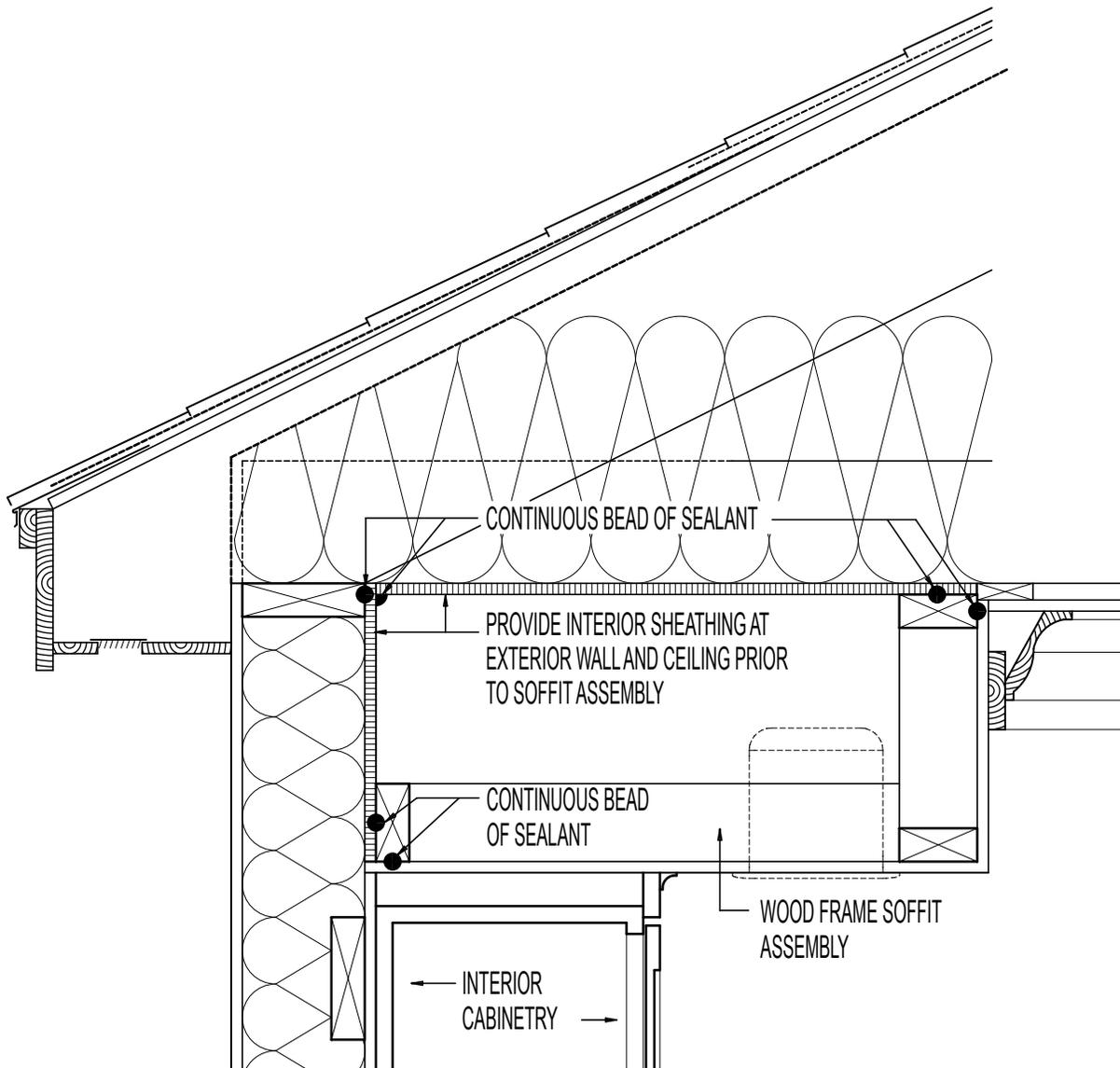
AIR SEAL AT CABINET SOFFIT // SINGLE-STORY
