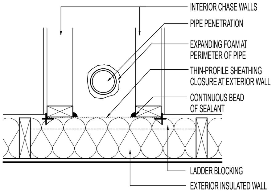
AIR SEAL AT CHASE WALLS // PLAN
